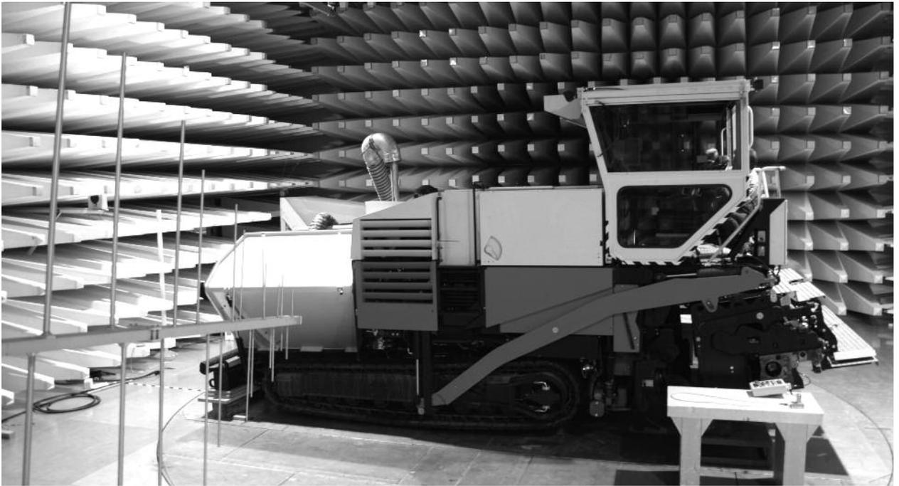
*Prüfung an einer Teermaschine (mit freundlicher Genehmigung der Fa. Dynapac GmbH)*
